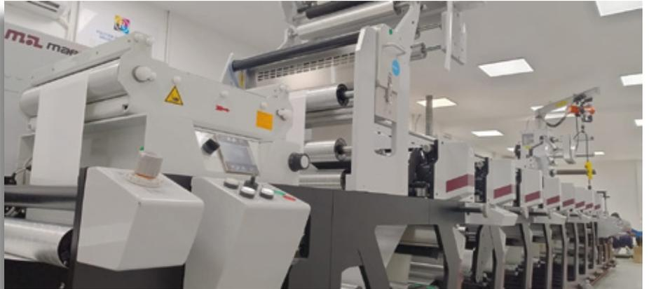
Con esta impresora logramos etiquetas de primera calidad. Cuanta con 8 Cuerpos impresores. Impresión de ambos lados, registro automático, opción de Mata adhesivo, ancho de la banda 430 mm, rango de repetición de impresión, Tecnología de impresión, velocidad, versatilidad, tinta de secado rápido, bajo costo, máxima Calidad de impresión y mayor gama de colores.
